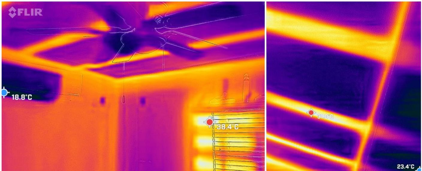
Imagen 5. Termografías después de la rehabilitación energética.
